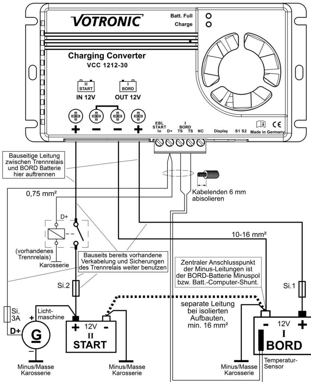
Hinweis: Der Rückladezweig des VCC 1212-30 zur Ladung/Ladeerhaltung der STARTER-Batterie aus der BORD-Batterie bei externer Netzladung ist hier nicht aktiv (das Trennrelais ist dann abgeschaltet).
