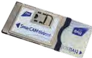
Tivùsat CAM-Modul HD mit inbegriffener Smart Card Geeignet um die TivùSat Sender und die HD Sat-Sender über den Receiver Force HD CI+ zu empfangen
