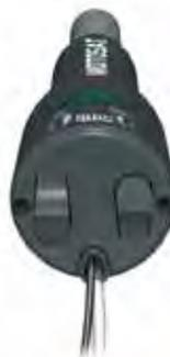
Die Neigung der Parabolschüssel lässt sich nun mithilfe zweier Tasten ändern; das Display zeigt die korrekte Neigung an, um den gewünschten Satelliten schnellstmöglich zu finden.
